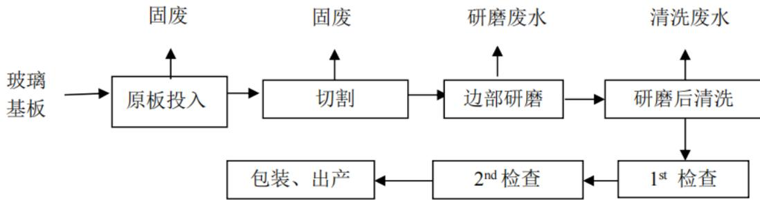
图 3.1 前加工工序流程图
